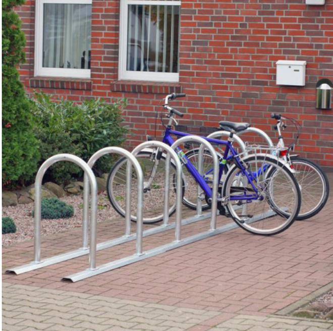
Fahrradparker zum Anlehnen und Anschließen von Fahrrädern. Als einseitige oder als zweiseitige Anlage nutzbar. Die Bügel sind aus  $\varnothing 48$  mm Rundrohr und werden mit den Bodenschienen aus gekantetem Stahlblech verschraubt. Anlieferung erfolgt zerlegt. Radabstand 700 mm, Höhe 825 mm, Breite ca. 550 mm.
